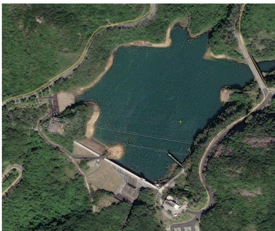
翠岭水库主要建筑物包括主坝、1 号副坝、2 号副坝、溢洪道、输水涵管和放空涵管组成。
